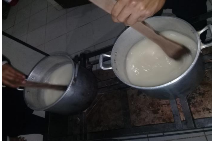
Fotografía 10 Mezcla y pasteurización de materias líquidas para obtener el producto
