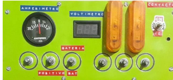
FIGURA 3.3: IMAGEN VISTO DE FRENTE DEL PANEL PRINCIPAL DEL PROBADOR DE ALTERNADORES
