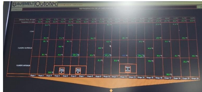
Figura 1.2.1-5 Refrigeración de la carcasa del horno
