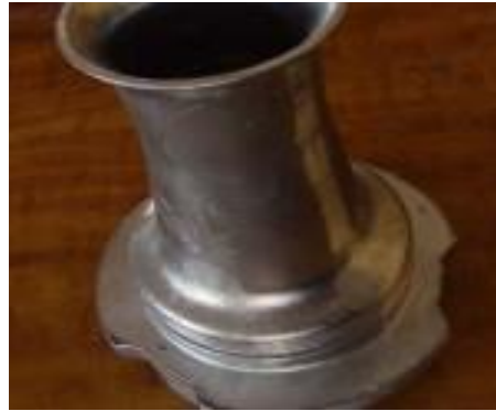
Figura 2.1.5-2 Venturi de fundicion de 3 patas "2"
