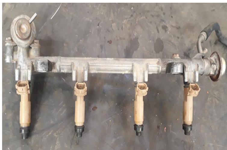
Figura 23. Riel de inyectores motor 3S-FE.
