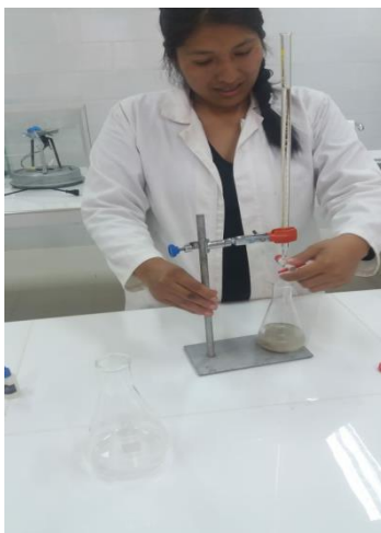
Fotografía 2: Titulación para el cálculo de acidez
