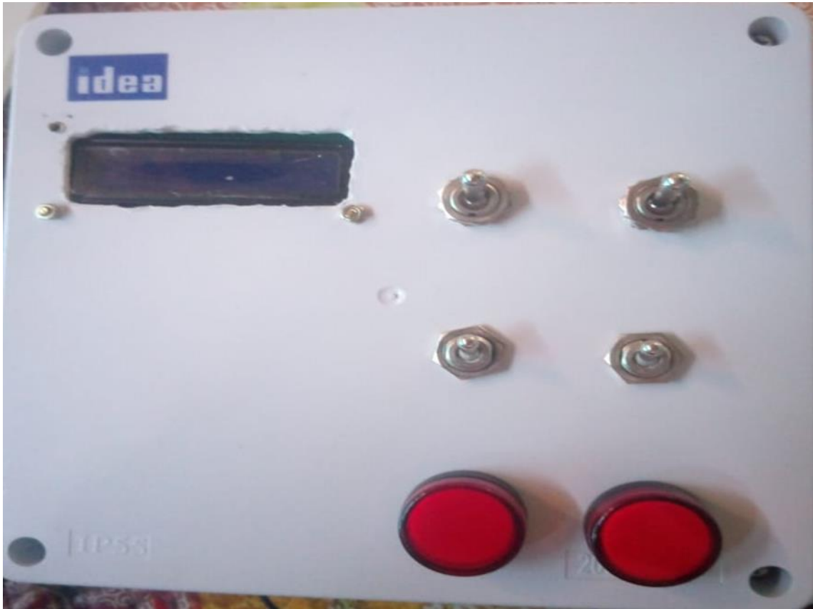
Figura N°14 – Caja protectora de potencia
