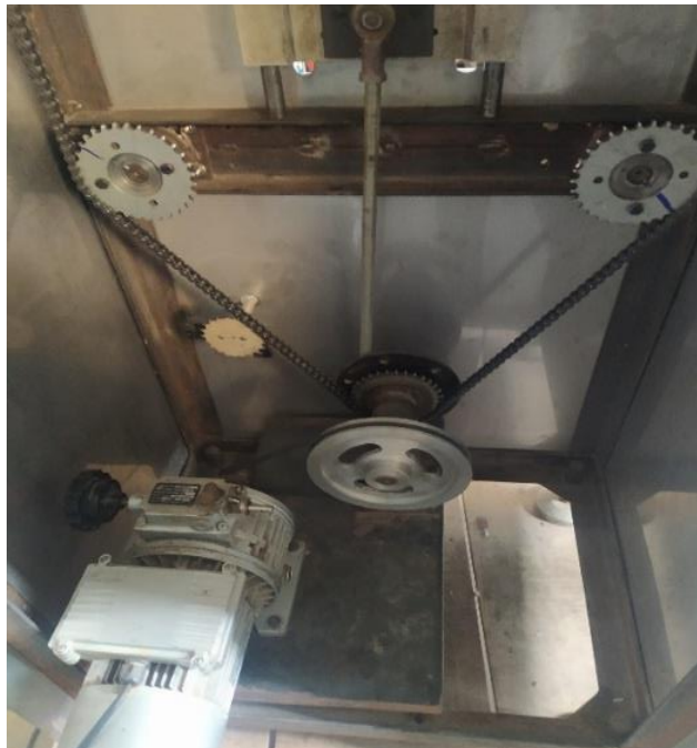
Fig. 3.17 Parte mecánica movimiento de los ejes de sellado y arrastre
