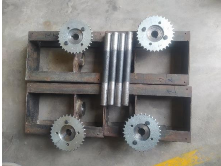
Fig. 3.16 Partes mecánicas de sellado horizontal y vertical
