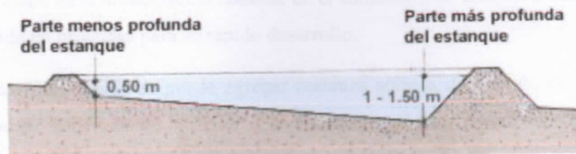
PERFIL DE LA PARED DE UN ESTANQUE
