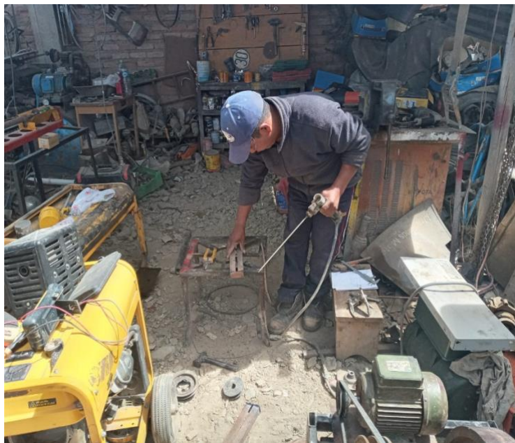
Fig.07 Ajuste de correderas para ubicación de motores eléctricos
