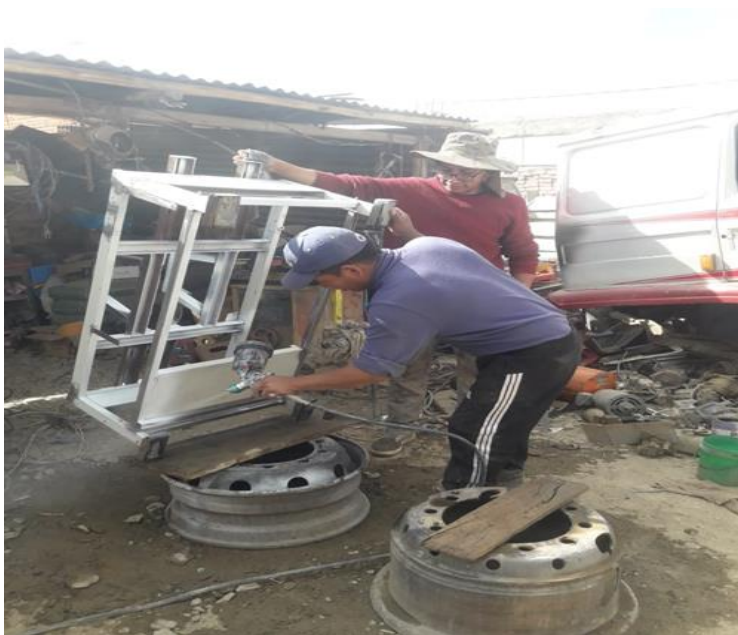
Fig.8 inicio del pintado de la estructura ( color base)
