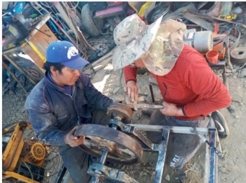
Fig. 12 Alineación de poleas y tensado de correas
