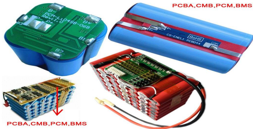
FIGURA N-30: BMS Sistema de gestión de baterías
