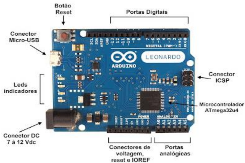
FIGURA N-5: Arduino Leonardo especificaciones y características
