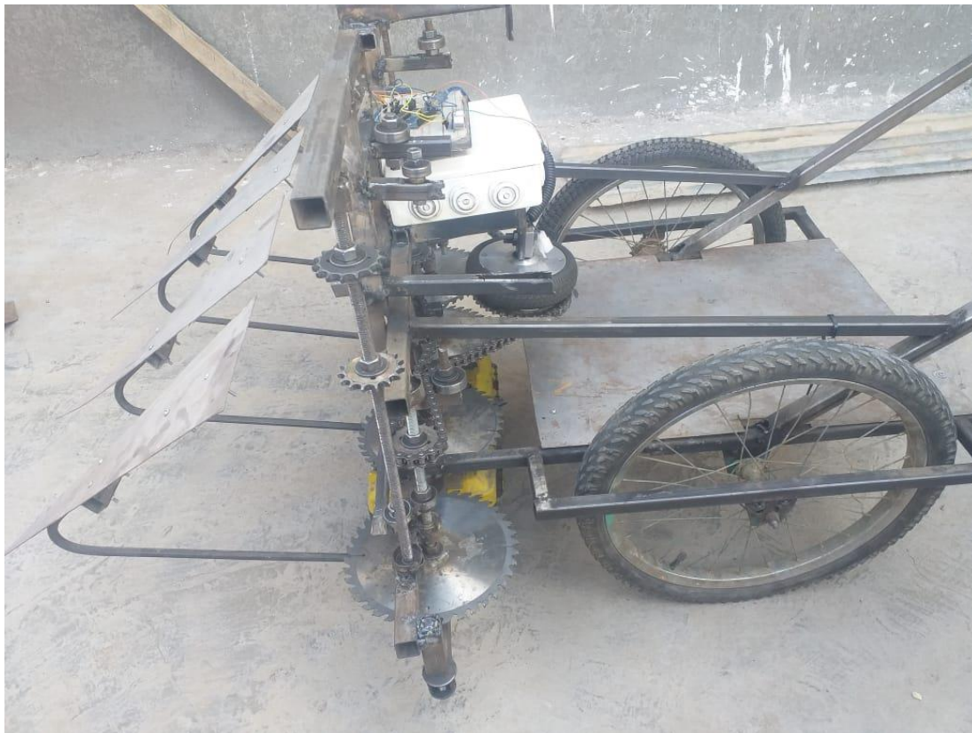
FIGURA N-42: Montado de circuito al chasis
