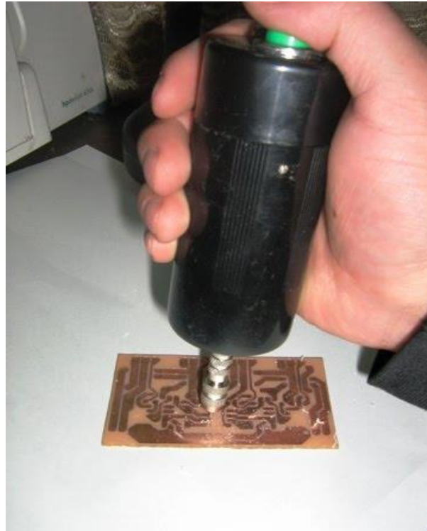
FIGURA N-40: Perforación de placa PCB
