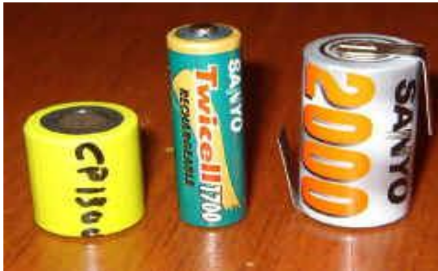
FIGURA N-27: Baterías de níquel
