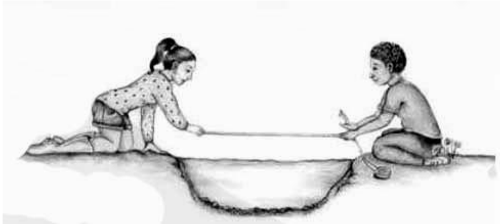
Figura 11. Forma para medir el perfil de la sección para un mejor aforo
