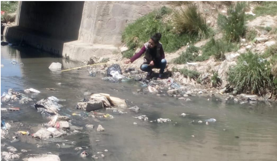
Fotografía 7. Medición del ancho del río
