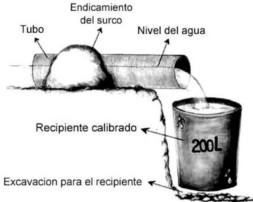
Figura 7. Forma de llevar a cabo el aforo por el método volumétrico
