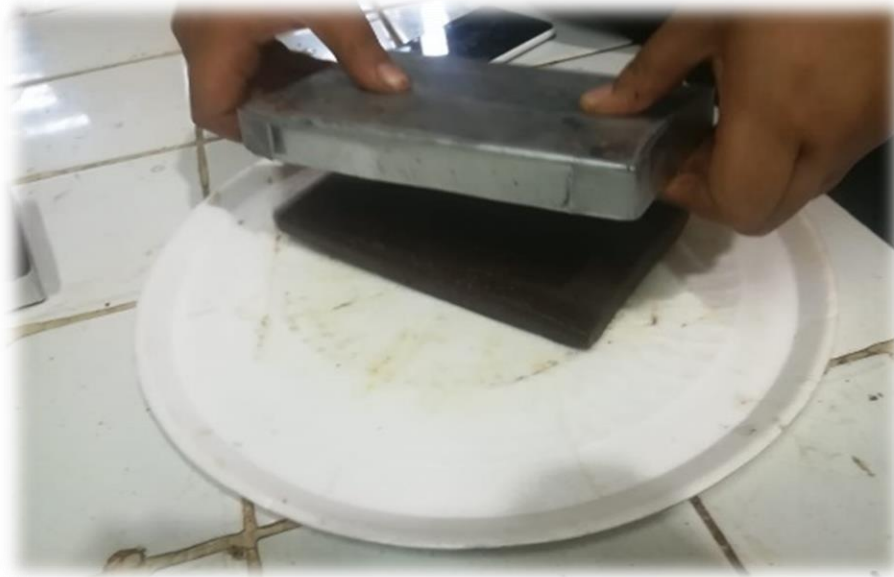
Figura 46. Desmoldado de las pastas.
