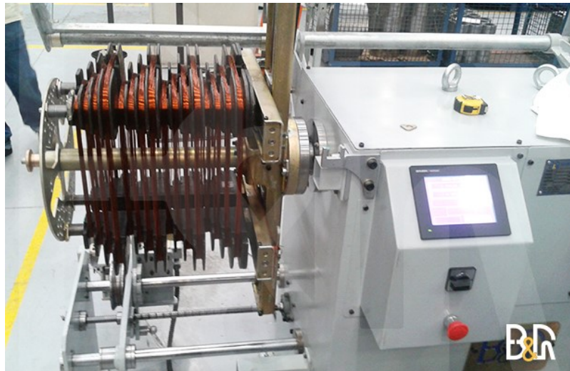
Figura 2.1 Bobinadora de motores eléctricos
