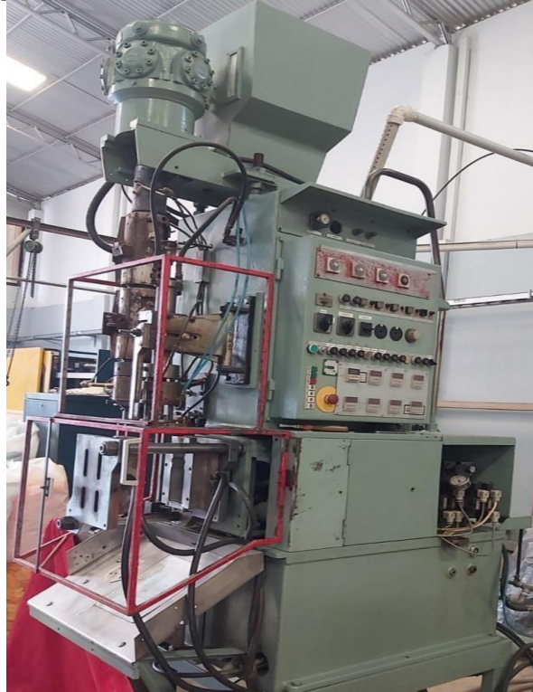
Figura N°3: soplado de manga de plástico.
