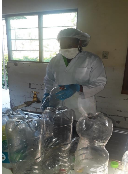
Figura 12. Lavado y desinfección de los envases.
