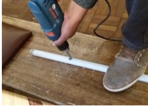
FOTOGRAFIA 15. Perforación de los tubos PVC
