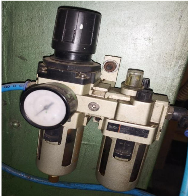
FIGURA N° 28: Unidad de mantenimiento
