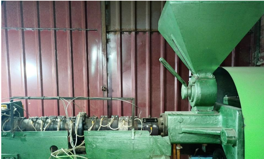
FIGURA N°22: Sensor de temperatura en la extrusión
