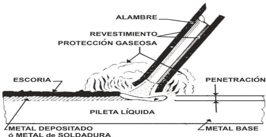
Imagen 1. Características del proceso de Soldeo SMAW
